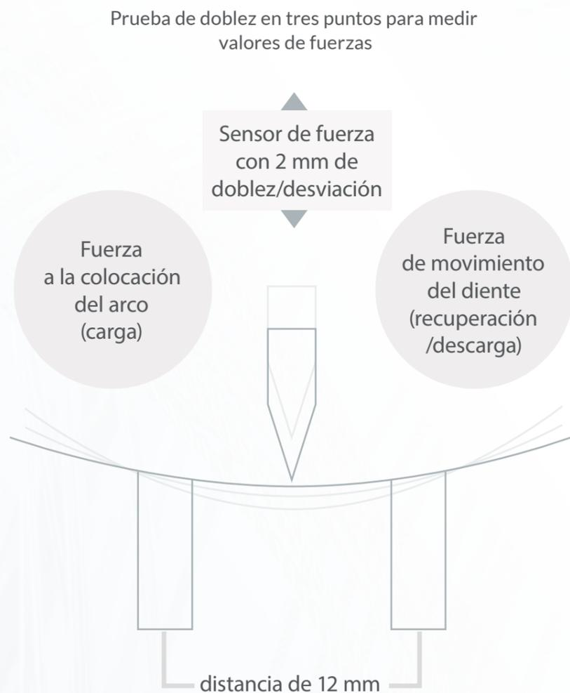
Se analiza la fuerza sobre el Níquel Titanio utilizando pruebas de dobleces/recuperación en 3 puntos, con un sensor que impacta contra el alambre y registra las fuerzas por todo el proceso desde la doblez hasta su recuperación. Todos los resultados de las pruebas son archivados en formato de gráfico de Histéresis.
