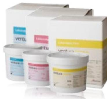
Yeso para trabajos de carácter general. Proporción agua / polvo : 26 ml / 100 g. Fraguado final (Vicat) : 10'. Expansión de fraguado (2 horas) : 0,13 %. Resistencia a la compresión (1 hora) : 34 MPa. No se distorsiona en los trabajos con acrílicos. Color: Amarillo / Rosa / Azul.
