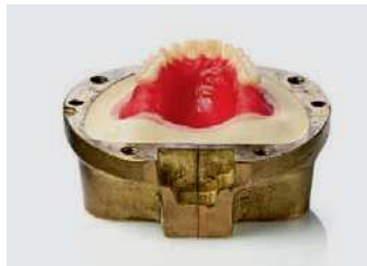
2. Colocación del modelo encerado en la mufla
