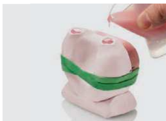
13. Fin del vaciado a la salida de la resina del canal opuesto
