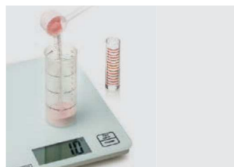
7. Pesar la resina, medir el monómero, mezclar vertiendo primero el monómero y después la resina
