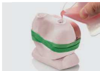
12. Verter el acrílico en uno de los dos canales de vaciado
