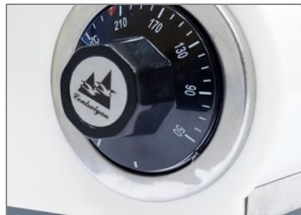
El mando específico te permite regular la temperatura de soldadura hasta 200 °C en base al papel que estas utilizando, liso o corrugado.
