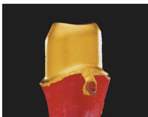
3. Eliminación del elemento auxiliar hecho de Pattern Resin LS para quitar fácilmente el coping metálico, evitando deformaciones.
