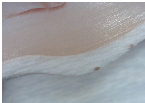
adhesión entre compuesto y Trilor®
