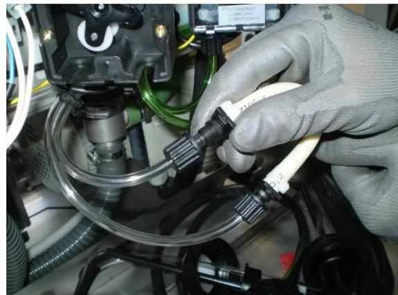
7. Sustituir el tubo de membrana conun otro del mismo tipo (véase la lista de piezas de repuesto suministrada por el fabricante).
