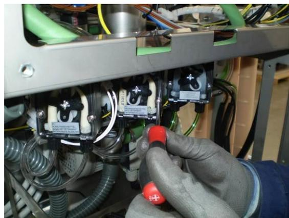
3. Extraer el tubo de membrana da la base de la bomba de dosificación.
