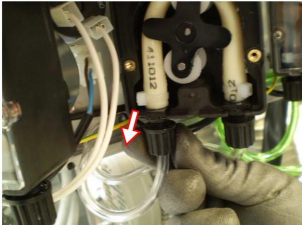
4. Girar manualmente el rotor, en sentido horario, hasta extraer completamente el tubo de membrana da la bomba de dosificación.
