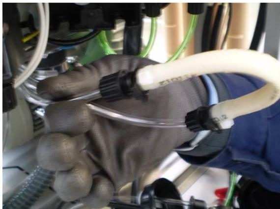
6. Afloje las abrazaderas del tubo/manguera y desconectar los tubos de suministro del producto químico da las juntas del tubo de membrana.
