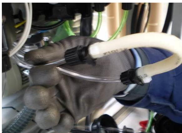
6. Afloje las abrazaderas del tubo/manguera y desconectar los tubos de suministro del producto químico de las juntas del tubo de membrana.
