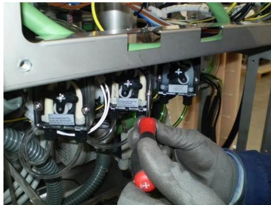
3. Extraer el tubo de membrana de la base de la bomba de dosificación.
