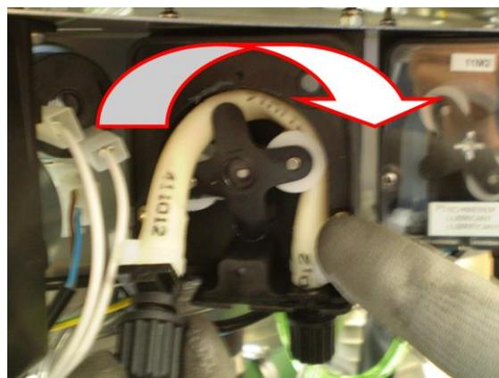
**ATENCIÓN: ¡el rotor de la bomba de dosificación gira solo en sentido horario!**
