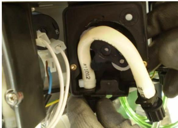
**ATENCIÓN:** ¡el rotor de la bomba de dosificación gira solo en sentido horario!
