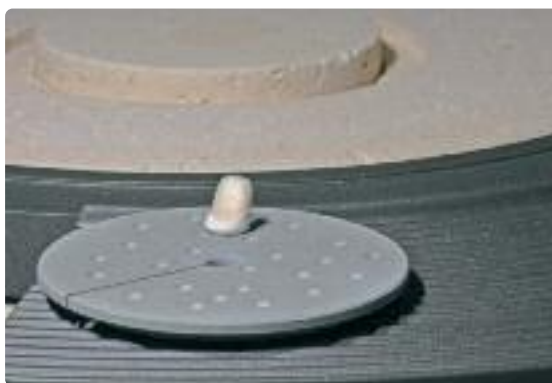
Retirar la plataforma de cristalización una vez finalizado el programa de cristalización y dejar que la restauración IPS e.max CAD alcance temperatura ambiente.
