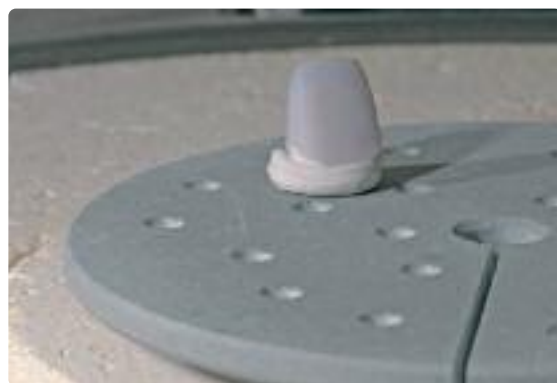
Situar la plataforma en el horno e iniciar la cristalización.
