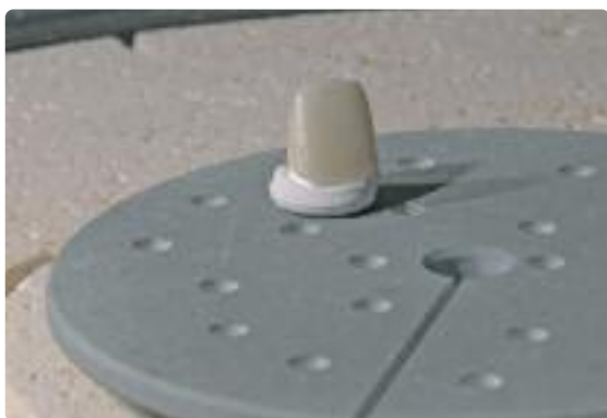
Retirar la plataforma de cristalización una vez finalizado el programa de cristalización y dejar que la restauración IPS e.max CAD alcance temperatura ambiente.
