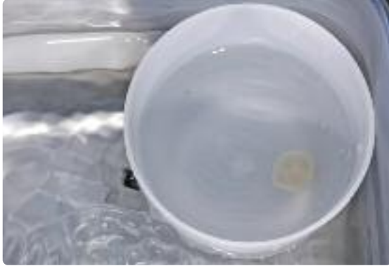
Eliminar los residuos con ultrasonido en baño de agua...
