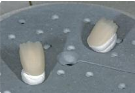
Retirar la plataforma de cristalización del horno una vez finalizado el programa de cristalización y dejar que alcance temperatura ambiente.
