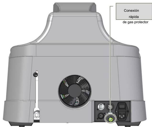
Fig. 6-12 – Conexiones rápidas para suministro de gas protector y aire comprimido
