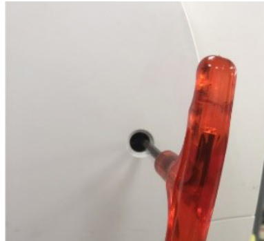
2. Inserte una llave hexagonal interna de 5 mm en el fondo interno del orificio y gire la llave en el sentido de las agujas del reloj hasta que se abra la puerta eléctrica.
