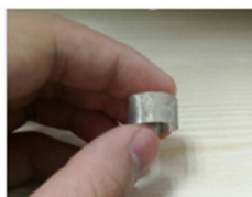
4. Limpie o reemplace la pantalla quitada de su tornillo.
