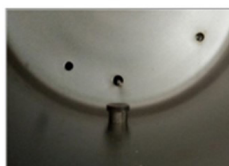
1. Busque el conector del filtro de la cámara.
