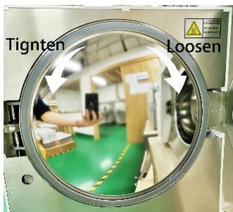
4. En ese momento, se puede ajustar la puerta del esterilizador. Mirando hacia la puerta, gírela en el sentido de las agujas del reloj para aflojarla o en el sentido contrario a las agujas del reloj para apretarla. En caso de fuga de aire, gire la puerta en sentido antihorario. Asegúrese de realizar un ajuste fino y no girar demasiado.
