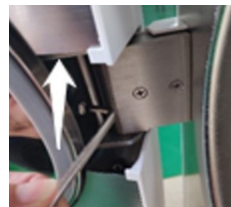
6. Apriete el perno con una llave Allen hacia arriba al finalizar el ajuste.
