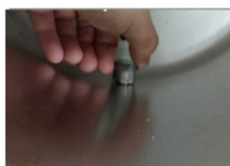
2. Afloje y retire el tornillo de la rejilla del filtro.
