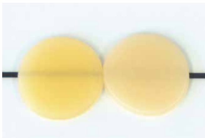
Cuerpos de ensayo cromático GrandioSO Unlimited (agrupación de tonos A3) antes de la fotopolimerización (izquierda) y después de la fotopolimerización (derecha)
