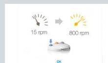
Pulse **OK** (Aceptar) o presione brevemente el botón azul del pedal para aceptar el aviso emergente y permitir que se ponga en marcha el micromotor MX-i.
