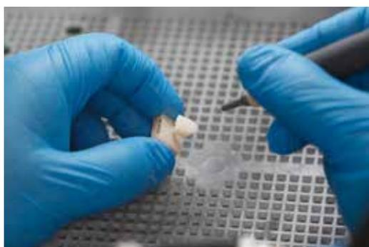
Antes de la personalización debe efectuarse el arenado de la superficie que se desea personalizar. ( $\text{Al}_2\text{O}_3$  50  $\mu\text{m}$ , 1,5 - 2bar).
