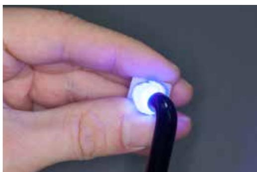
Fije las diferentes masas o capas de Flow polimerizando entre cada aplicación.
