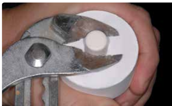
El pistón Alox queda muy limpio al extraerlo con las pinzas del material de revestimiento. Comprobar la limpieza y arenar con Al_2O_3 , en caso necesario.
