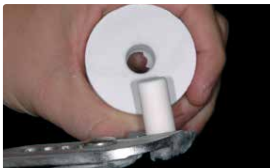
El pistón Alox queda muy limpio al extraerlo con las pinzas del material de revestimiento. Comprobar la limpieza y arenar con Al_2O_3 , en caso necesario.
