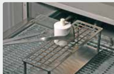
Cuando haya finalizado el programa de inyección, colocar el cilindro de revestimiento caliente sobre la gradilla de enfriamiento usando las pinzas para el cilindro de revestimiento y dejar enfriar a temperatura ambiente.
