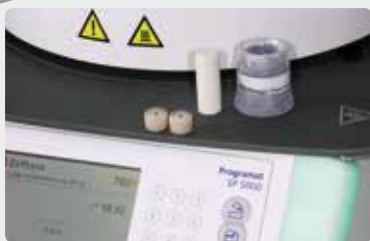
Preparar un pistón IPS Alox Plunger frío y una pastilla IPS InLine PoM fría del color deseado.
