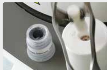
Después, introducir el pistón IPS Alox Plunger recubierto con polvo en el cilindro de revestimiento caliente .
