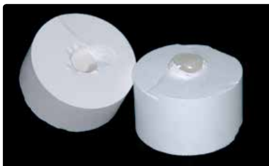
Separar el cilindro de revestimiento con un disco separador.
