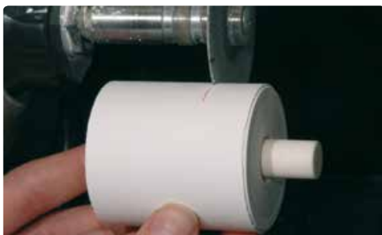
Separar el cilindro de revestimiento con un disco separador.
