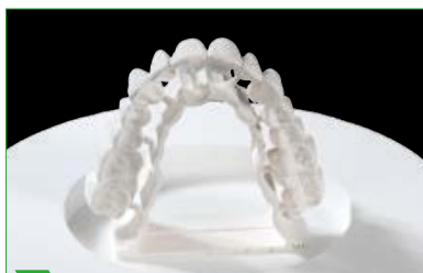
5 Restauración con soporte de sinterización, separada y repasada.
