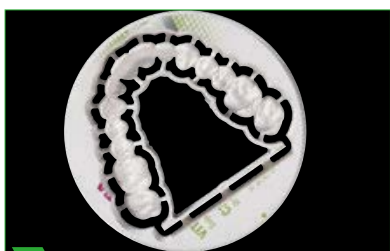
1 Puente con soporte de sinterización esqueletizado tras el proceso de fresado.
