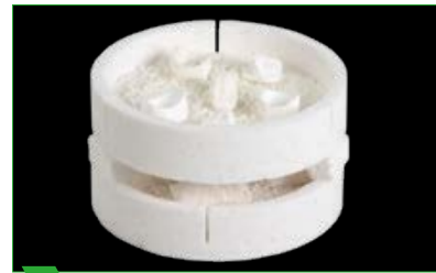
6 Sinterización apilada de restauraciones Color/Multicolor.
