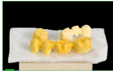
6 Es imprescindible secar las restauraciones antes de la sinterización.
