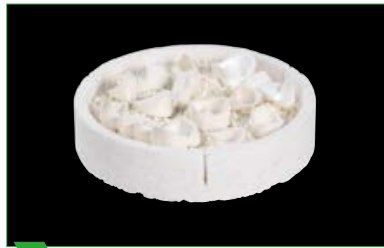
5 Bandeja de sinterización MS llena de restauraciones.
