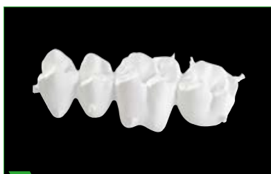
1 Restauración fresada directamente tras el proceso CAM.
