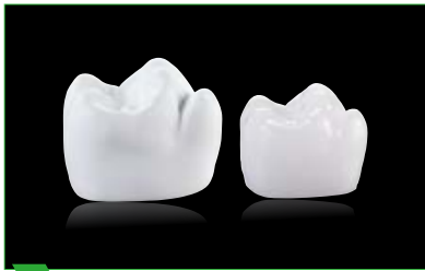
4 Molar antes y después de la sinterización; contracción de sinterización del 20 por ciento, aprox.
