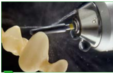
1 Mecanizado con turbina y refrigeración por agua.
