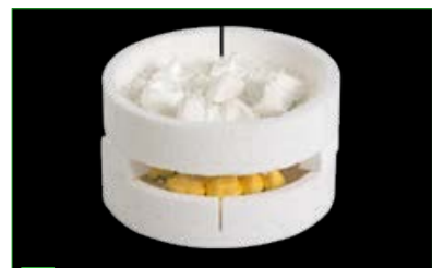
9 Sinterización simultánea de restauraciones Color/Multicolor precoloreadas y restauraciones coloreadas manualmente.
