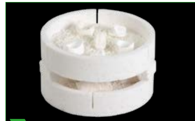
6 Sinterización apilada de restauraciones Color/Multicolor.
