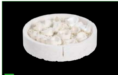
5 Bandeja de sinterización MS llena de restauraciones.
