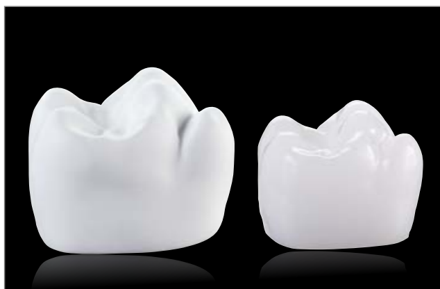
Figura 6: Ejemplo de contracción por sinterización de dióxido de circonio de un 20 %, aprox.
