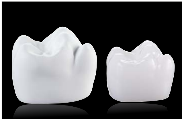
Figura 6: Ejemplo de contracción por sinterización de dióxido de circonio de un 20 %, aprox.
