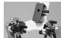
**6.2.3** Einrichttisch bis zum Anschlag in den Instrumententräger einsetzen und fixieren.
