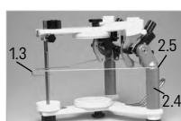
**6.1.4** Die Okklusionsebene auf das Gummiband ausrichten. Den Inzisalpunkt zwischen den unteren Zentralen oder am Wachswall auf die Spitze des Inzisalpunktzeigers (1.3) ausrichten.
