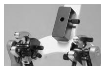
6.2.3 Introducir hasta el tope la placa de orientación en el porta-instrumentos, y fijar.
