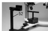
6.5.5 UTS-Registrat am Registriergelenkträger (52) befestigen und die Bissgabel mit der Bissgabelstütze sichern.
