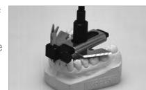
Fixer ensuite le niveau de repérage sur le modèle avec de la cire ou un élastique.
