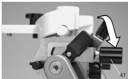
Liberando inoltre la gomma di centrica (4.2), è possibile separare la branca superiore da quella inferiore dello Stratos 300.
