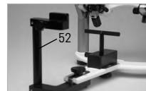
6.5.5 Monter l'enregistrement (52) pris avec l'arc de transfert ATU et soutenir la fourchette grâce au support.
