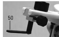
6.5.3 Mettre en place le support de fourchette d'enregistrement (51) dans le support-instrument (40) fixé sur la partie inférieure (2.2).
