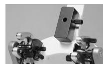
6.2.3 Inserire la piastra di posizione nel portastrumenti fino all'arresto e fissarla.
