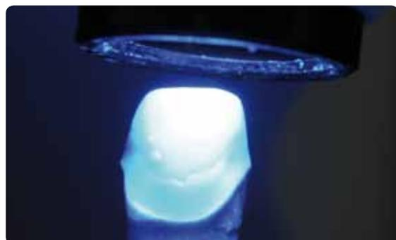
Aplicar el Liner con un grosor mínimo de capa de 150  $\mu\text{m}$ . Fijar cada segmento durante 20 segundos con un aparato de fotopolimerización Quick.
