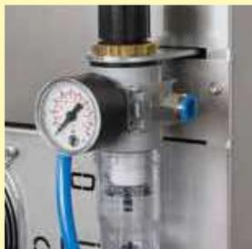
Enfriamiento rápido mediante aire comprimido
