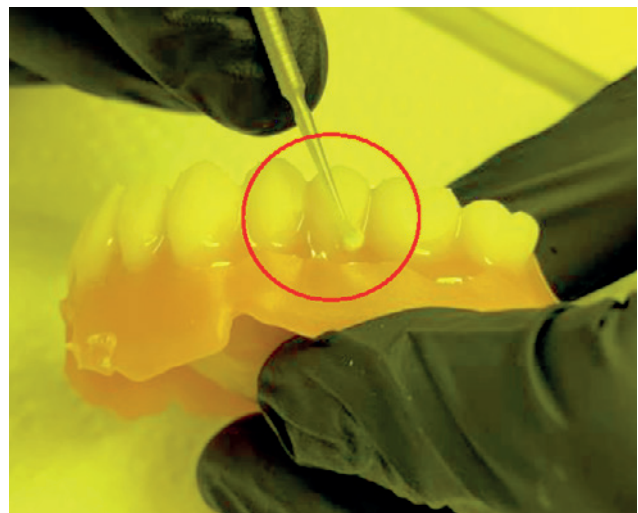
Figura 17: Eliminación del excedente con un pincel
