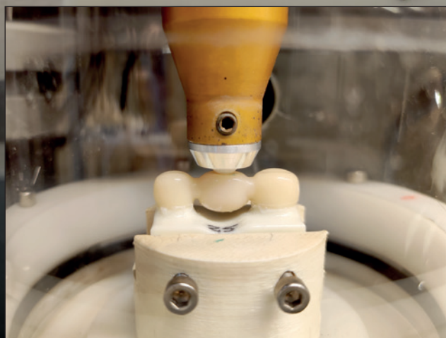
Figuras 6 y 7: Diseño de ensayo de la simulación de masticación para puentes provisionales de largo plazo
