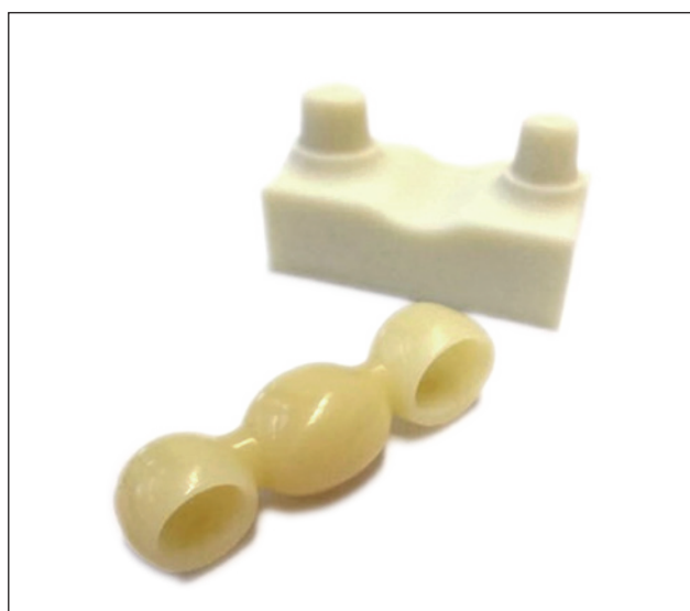
Figura 8: Geometría del objeto de ensayo para la simulación de masticación
