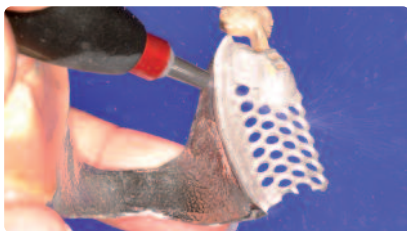
Arenado con Al_2O_3 tipo 100, con una presión de 2-4 bar/29-58 psi
