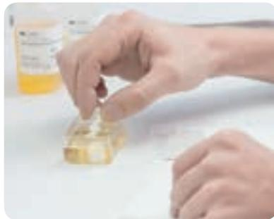
Las estructuras o restauraciones monolíticas pueden realizarse mediante tinción por inmersión monocromática, un proceso rápido y fácil en 2 minutos, en el que el líquido de tinción es absorbido totalmente y de forma homogénea por el dióxido de zirconio. Esto significa que no va a aparecer «ningún punto blanco» si se hacen ajustes.
