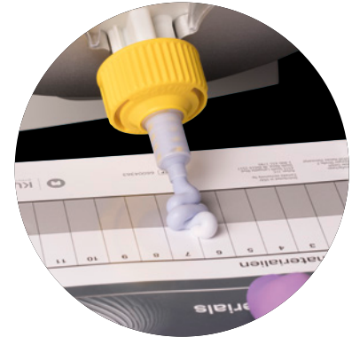
Imagen 37: Deseche los primeros 2-3 cm para nivelar los dos materiales.
