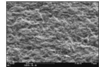
Superficie de la cavidad de arriba aumentada 500 veces. La rugosidad de la estructura de la superficie es uniforme en toda la cavidad.
