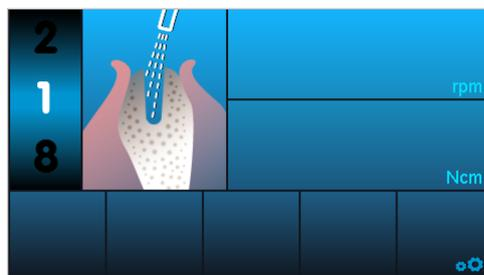
La función de enjuague sirve para transportar el líquido de enfriamiento y para la puesta en servicio de la iluminación en el instrumento. Para ello no se activa el motor. En cualquier instante se puede acceder manualmente a la función de enjuague.
