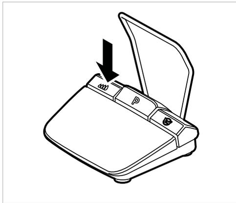
Durante el tratamiento se puede ajustar la cantidad de refrigerante suministrada con la tecla de bomba del reóstato de pie. El valor modificado se muestra en el display, y se mantiene para la siguiente aplicación.
