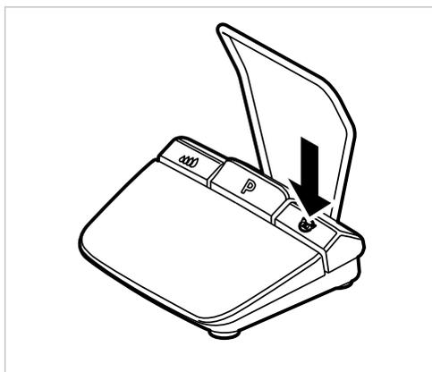
Durante el tratamiento se puede modificar el sentido de giro del motor con la tecla de sentido de giro del motor del reóstato de pie. El sentido de giro del motor modificado se muestra en la pantalla. Por motivos de seguridad no se guarda el sentido de giro hacia la izquierda.
