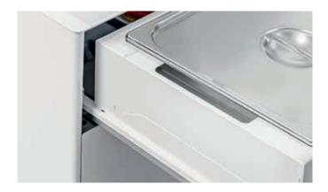
Fluidez extrema y mecanismo Soft Close (amortiguación al cerrar el cajón). Las guías han sido probadas para un uso continuo mediante ciclos de aperturas/cierres con una frecuencia de 7 ciclos por minuto. Estas pruebas garantizan el funcionamiento de las guías durante 60.000 ciclos, es decir, un uso continuo superior a 20 años.
