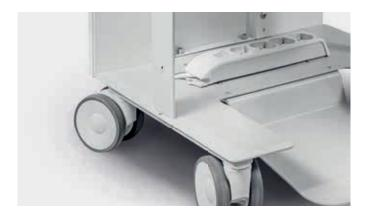
Ruedas giratorias de gran fluidez con freno. Instaladas sobre rodamientos de bolas con una resistencia de carga de 100 kg, gracias a su amplio diámetro (100 mm), pueden superar obstáculos, como, juntas del suelo, zonas de unión del pavimento con diferentes alturas, pequeños obstáculos.
