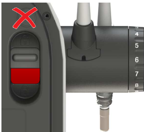
Le cordon de la pièce à main n'est pas correctement connecté.
