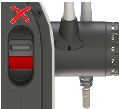
Het handstuksnoer is niet volledig aangesloten.
