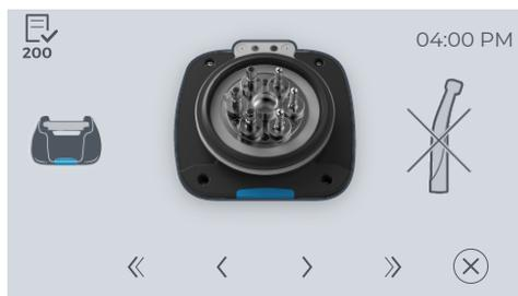
3. Siga hasta el siguiente paso en esta opción de Check & Clean pulsando la tecla "*Navigation nächster Schritt*" (navegación al siguiente paso).
