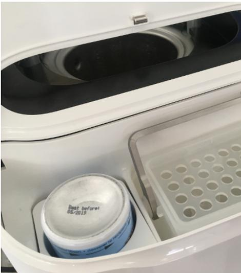
4. Gire con cuidado el frasco de lubricante en sentido horario hasta que aprecie resistencia.
