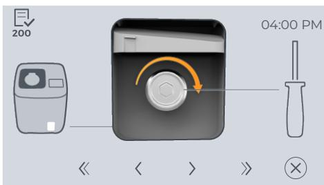
14. Atornille la tapa de la cubierta del filtro en sentido horario con el destornillador.
