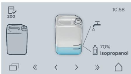
8. Llene el depósito de agua residual limpiado hasta que el agua alcance la marca que figura en la etiqueta.
