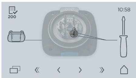
4. Compruebe la fijación del adaptador a la tapa tirando levemente de cada adaptador.
