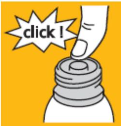
2. Presione sobre la parte superior negra del frasco de lubricante a fin de soltar el bloqueo de transporte.
