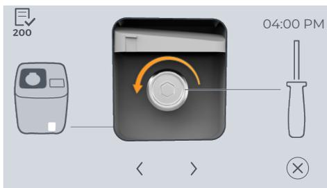
3. Abra hacia arriba la tapa de la conexión de agua residual.
