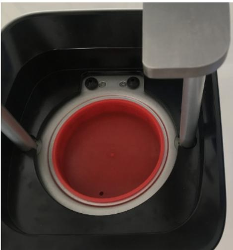
2. Coloque el tapón rojo de transporte en la cámara.
