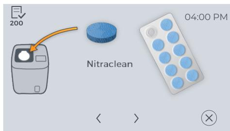
2. Coloque una pastilla de limpieza NitraClean en la cámara drenada.
