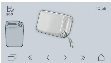
7. Drene el depósito de agua residual. Elimine el agua residual conforme a la normativa nacional y a las disposiciones vigentes sobre eliminación de residuos.
