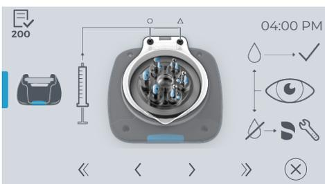
10. Inyecte el agua con la jeringa a través de ambos orificios en los canales de la tapa Blue (tal y como se muestra en la imagen).
