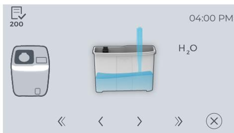
3. Si no dispone de una conexión automática de agua para su DAC Universal, llene el depósito de agua (mín. 1,0 litro, máx. 2 litros) con agua desmineralizada/destilada (conductividad del agua  $<3,0 \mu\text{S}/\text{cm}$ ).
