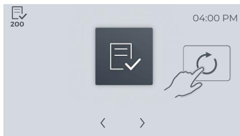
Un proceso Check & Clean se dará por finalizado y se visualiza a modo de registro en el historial cuando el último paso del proceso Check & Clean se ha visualizado en la pantalla y se ha efectuado un ensayo.
