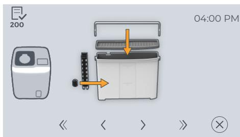
2. Monte el depósito de agua colocando de nuevo el asa, la tapa y el flotador, incluida la guía del flotador, en el depósito de agua.
