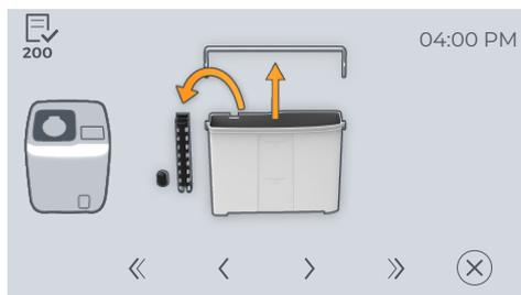
5. Desmonte el depósito de agua retirando el asa, la tapa y el flotador, incluida la guía del flotador.
