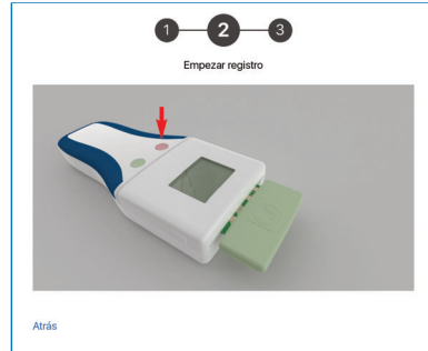
Figura 21: Segundo paso: pulse el botón de la izquierda (rosa) para empezar
