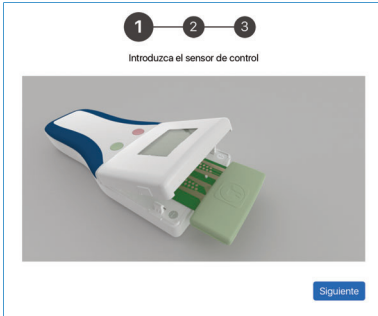
Figura 20: Primer paso del test del sensor: inserte el sensor de prueba en el dispositivo
