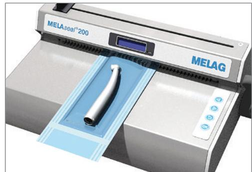
2. Presione la palanca de sellado hacia abajo hasta que encaje.
