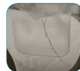
Composite convencional: propagación de las grietas a través del relleno.
