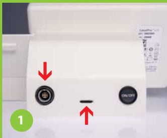
1 Conecte la unidad básica a la red eléctrica (↓). Compruebe si la tarjeta SD está colocada en su ranura (↑) en la parte posterior de la unidad básica.
