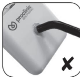
Non viene mantenuto direttamente sopra all'anello di misurazione: l'indicatore mostra un risultato errato.
