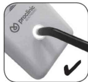
La guida della luce (priva del tappo protettivo) si incastra perfettamente nell'anello di misurazione della luce: l'indicatore mostra un risultato corretto.
