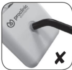
No se mantiene directamente sobre el círculo de medición: la aguja muestra un resultado incorrecto.
