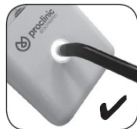
A guia de luz (sem a tampa de proteção) encaixa perfeitamente no círculo de medição de luz: a agulha apresenta um resultado correto.
