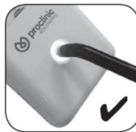
La guía de luz (sin el tapón protector) encaja perfectamente en el círculo de medición de luz: la aguja muestra un resultado correcto.
