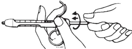
Visser les crochets spiralés dans le sens des aiguilles d'une montre dans le bouchon en caoutchouc en exerçant une légère pression.
