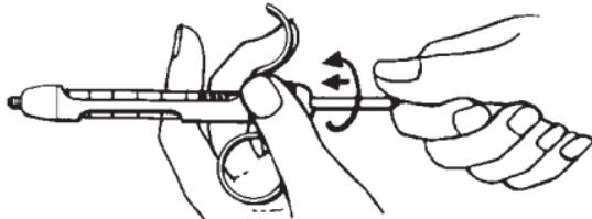
Περιστρέψτε το ελικοειδές άγκιστρο με τη φορά των δεικτών του ρολογιού μέσα στο λαστιχένιο στόμιο, ασκώντας ελαφρά πίεση.
