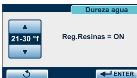
La indicación "regeneración resinas" (ON/OFF) señala si la gestión de la regeneración de las resinas está activa y depende del valor de dureza configurado.
