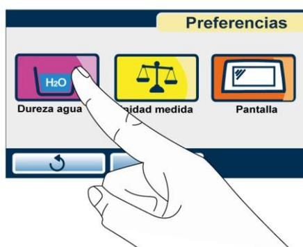
Operar en los cursores indicados en la figura para configurar la dureza del agua.
