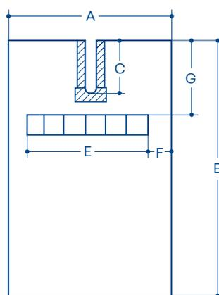
270224 - Con fisura en U adhesiva y pasante para tubo de aspiración
