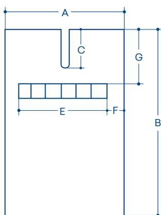
270223 - Con fisura en U sin adhesivo y pasante para tubo de aspiración
