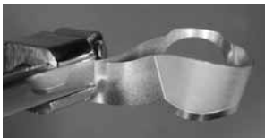
Voorbeeld van een correct gespannen band; het matte, verdunde deel wijst naar buiten.
