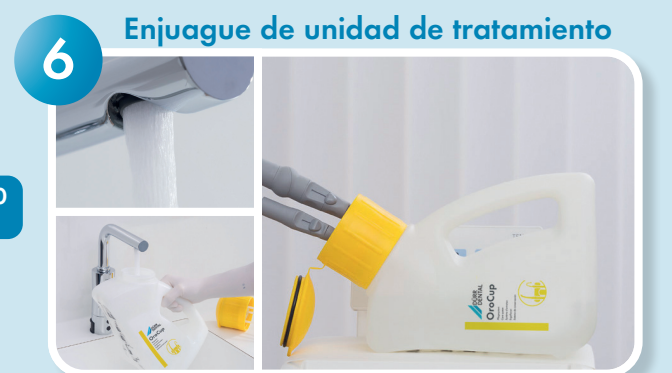
Aspirar 2 litros de agua durante la reactivación
